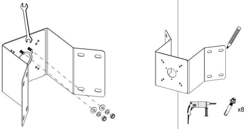
3. Los 4 orificios para tornillos en el centro se utilizan para montar directamente las cámaras speed dome PT. en los ori orificios para tornillos en los bordes se utilizan para montar la caja de alimentación AA-351, AA-352, AM-718
