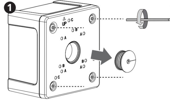
Se requiere un conducto de 3/4" para enrutar los cables con conexión impermeable.
