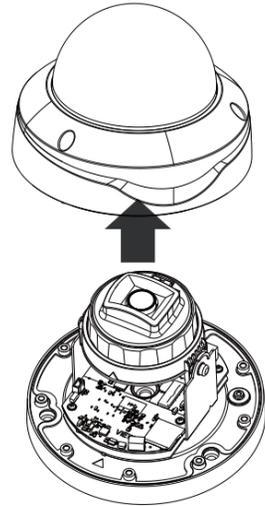
**5** Pase el cable Ethernet de la cámara por el orificio central de la caja y el sello de goma.
