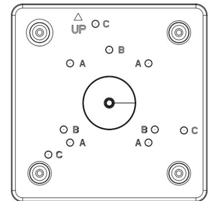
**9** Asegure la cubierta superior ajustando 4 tornillos de cabeza hexagonal
