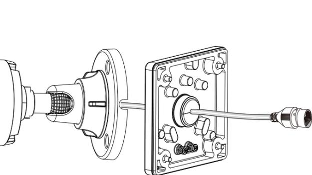
**6** Instale los componentes a prueba de agua del prensaestopas en su cable Ethernet siguiendo la QIG de su cámara. El prensaestopas se colocará dentro de la protección de la caja.
