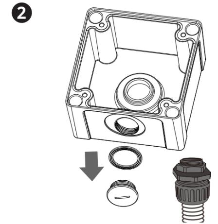
Instale el prensaestopas y pase los cables a través de él.
