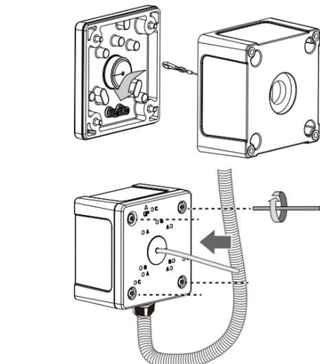
**10** Instale la cámara utilizando los orificios de montaje correspondientes con los tornillos de cabeza hexagonal incluidos.
