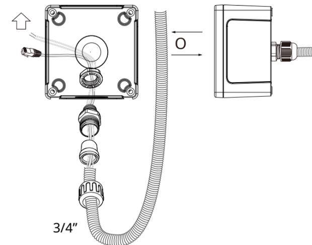
**7** Asegúrese de que el sello de goma esté correctamente instalado en el orificio central. El borde exterior del sello debe atravesar y cubrir el borde del orificio.
