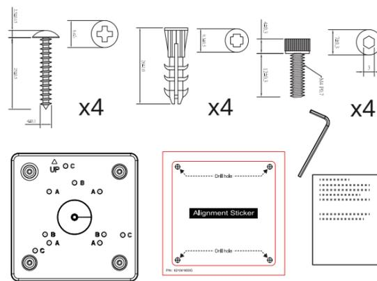
**3** Coloque la etiqueta de alineación incluida en la posición que prefiera. Taladre agujeros en la pared e instale la caja de conexiones. Si el espacio detrás de la pared lo permite, también puede pasar los cables a través de la pared.
