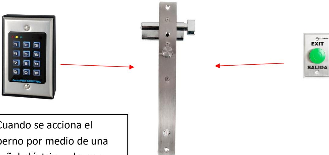
Cuando se acciona el perno por medio de una señal eléctrica, el perno permanecerá retraído hasta que el sensor detecte la puerta.
