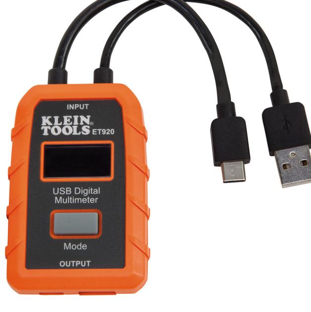
El modelo ET920 de Klein Tools es un multímetro digital USB para puertos USB Tipo A y Tipo C. Mide y muestra de forma precisa y fiable el voltaje, la corriente, la capacitancia, la energía, y la resistencia de un puerto USB, de manera simultánea. Funciona con cualquier puerto USB-A y la mayoría de puertos USB-C, incluyendo puertos Quick Charge® de Qualcomm que tengan la capacidad de suministrar energía. NO necesita baterías ya que usa energía de la fuente para funcionar.
