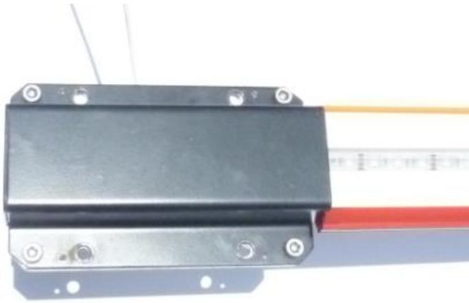
8.- MONTAR EL BRAZO A LA PLACA SOPORTE DE LA BARRERA – PASAR PRIMERO LOS CABLES DE LOS LEDS AL INTERIOR DEL GABINETE.
