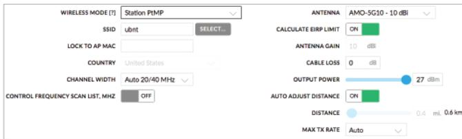
**SSID** Si el dispositivo está funcionando en *Punto de acceso PTP*, *Punto de acceso PTMP* *AirMax AC*, o *Punto de acceso PTMP AirMaxMixed* modo, especifique el nombre de la red inalámbrica o SSID (identificador de conjunto de servicios) utilizado para identificar su WLAN. Todos los dispositivos cliente dentro del alcance recibirán mensajes de difusión del AP que anuncien este SSID.
