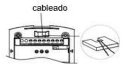
3) Orificio de cableado: Retire el tapón de espuma, tire del cable a través y restablecer el tapón de espuma.
