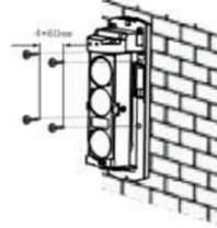
4) Los cuatro orificios con las tuberías de expansión, fíjarlos con tornillos.
