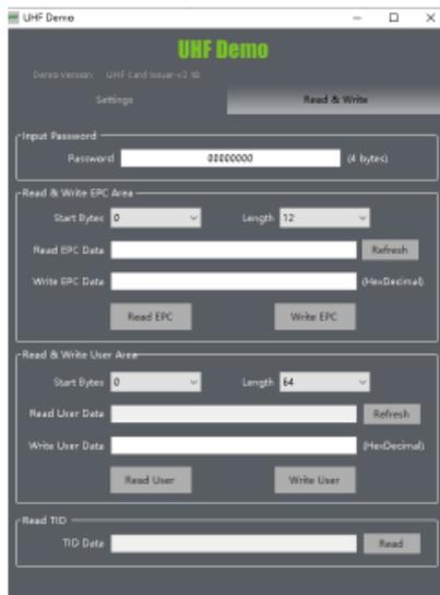
A través de la demostración, el usuario puede configurar la frecuencia de trabajo y el formato de salida de datos para el emisor de la tarjeta, también puede escribir y leer información de datos de tarjetas UHF.
