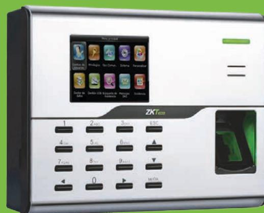
UA860 es una terminal biométrica con pantalla a color de 2.8 pulgadas, diseñada para realizar la gestión de Tiempo y Asistencia y aplicaciones de Control de Acceso básico. Integrado con el lector de huella digital BioID para un reconocimiento y verificación de forma eficaz, así como Wi-Fi interno para una comunicación conveniente.
