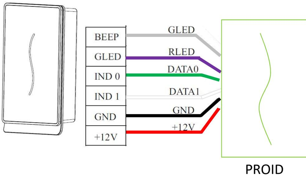
1- Realizar la conexión con el equipo Stand Alone en la entrada wiegand como se muestra en la figura.
