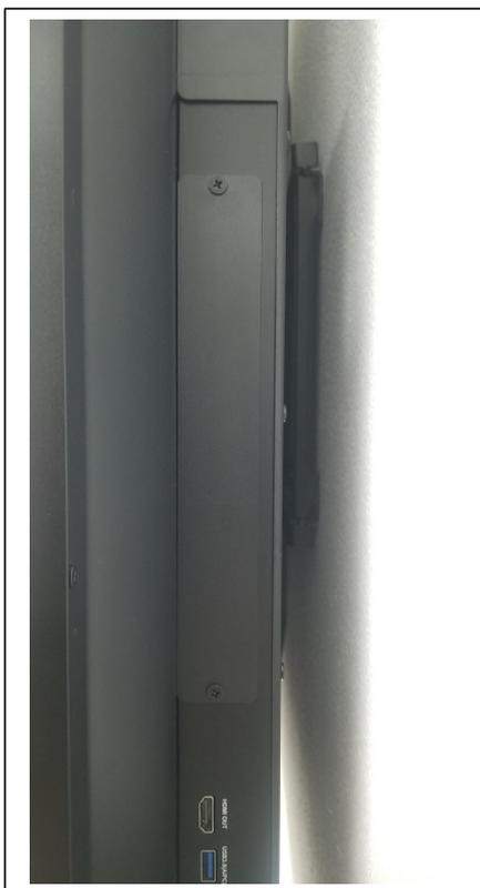
**1.2** Como pueden observar en la imagen , tenemos en la parte posterior de nuestra pantalla, del lado derecho veremos una placa con dos tornillos, solo debemos retirarlos para liberar la bahía del modulo OPS.
