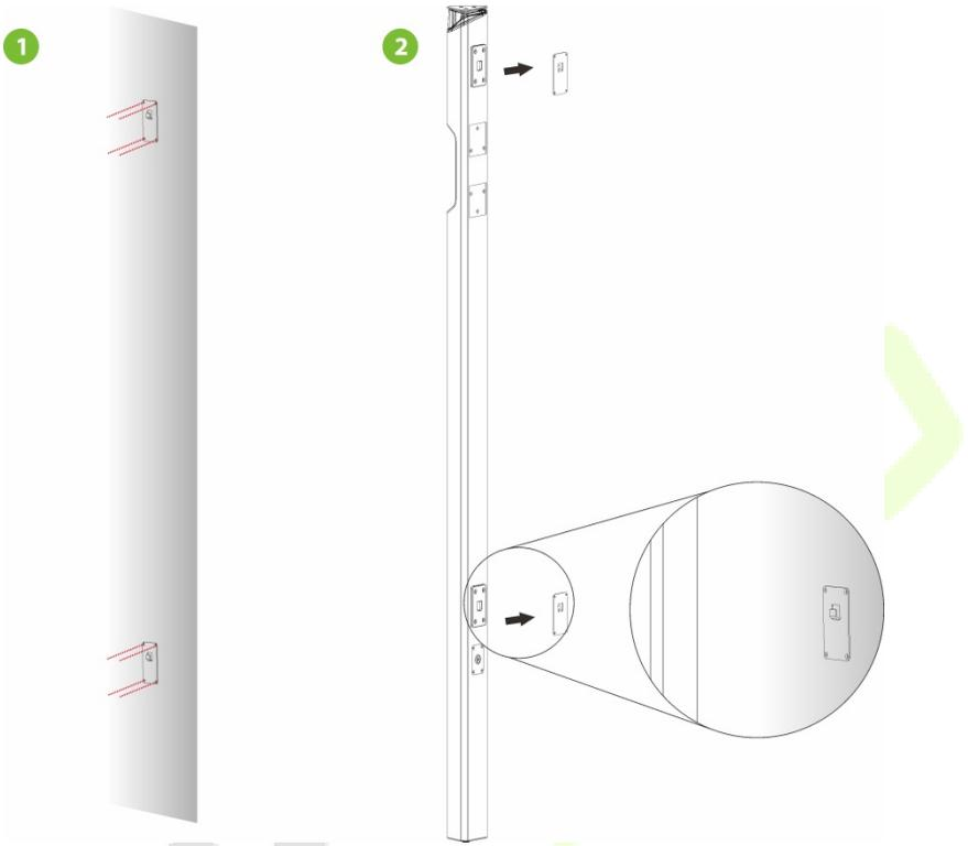
1. Fije las placas traseras en la pared según la posición del poste utilizando tornillos de montaje en pared;
