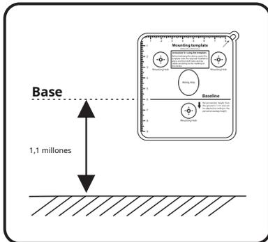
Pegue el adhesivo de la plantilla de montaje en la pared y taladre los orificios de acuerdo con el papel de montaje.
