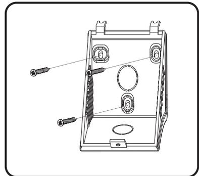
Fije la placa trasera en la pared con tornillos de montaje en pared.
