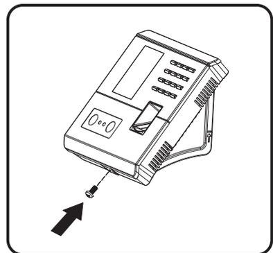
Fije el dispositivo a la placa posterior con un tornillo de seguridad.
