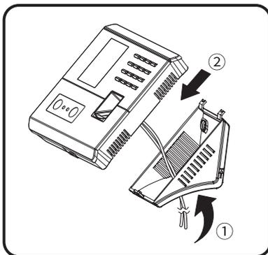
Después de pasar los cables a través del orificio de cableado y conectarlos al dispositivo, luego fije el dispositivo a la placa posterior de arriba a abajo.
