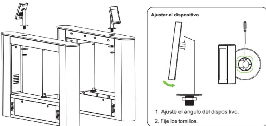
Pase el cable a través del soporte antes de la instalación.
