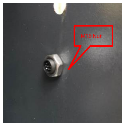
(b) La conexión del cableado pasa a través de la junta y tuerca.
