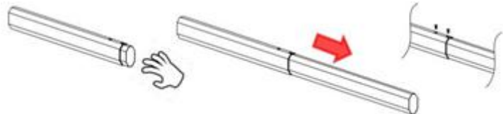
Figura 1 Conecte el brazo de la pluma principal con el brazo secundario con 2 tornillos
