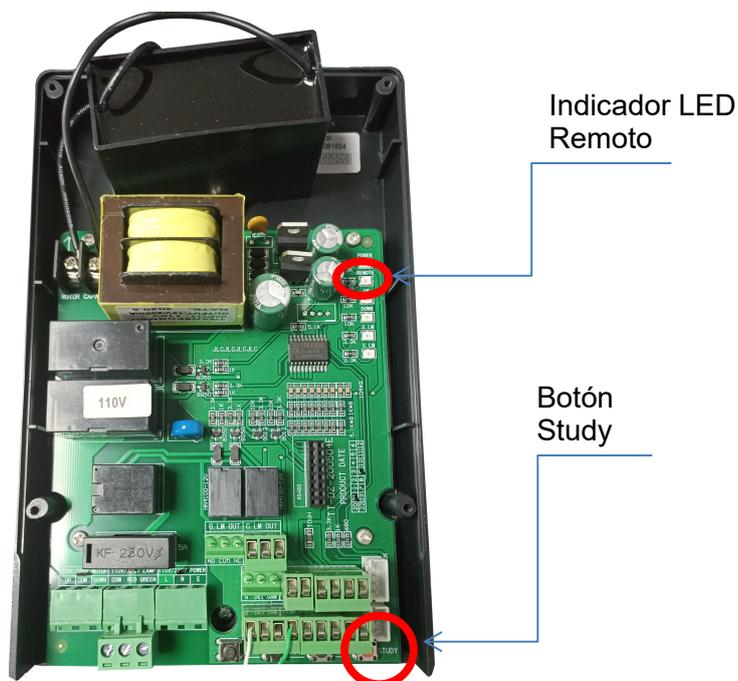
**Eliminar código:** en el estado de parada, presione el botón "Study" en el controlador principal hasta que el indicador REMOTO esté encendido, continúe presionando y manteniendo presionado el botón "Study" hasta que el indicador REMOTO esté apagado y se complete la eliminación del código. (Nota: se eliminan todos los códigos).
