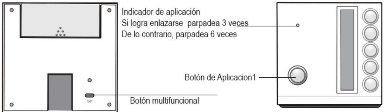
4.2 Después de conectar correctamente la lámpara Rainbow, todas las teclas del panel se convertirán en botones de control de la lámpara Rainbow y no se pueden utilizar en otros switches o Enlazamiento.
