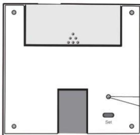
② Después de la conexión de red, el indicador de sistema permanece encendido 2 segundos y luego se apaga
