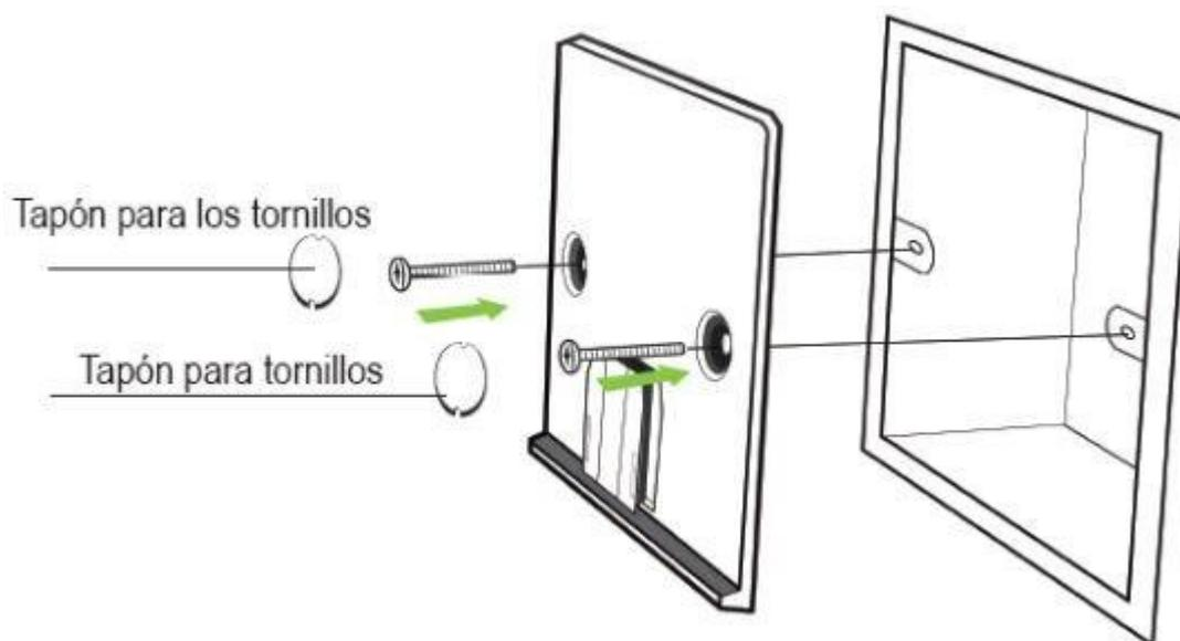
② **Instalación directa:** Haga dos perforaciones en la posición correcta en la pared y coloque el tubo expansor dentro de las perforaciones. Fijar la Base grande o la base pequeña en la posición correcta a través de 2 Tornillos para expansores.
