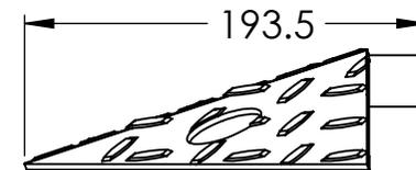
1. Fabricado en lámina de acero antiderrapante SAE 1008 rolada en caliente calibre 11 y placa de acero ASTM A36 de 6.35 mm (1/4").
