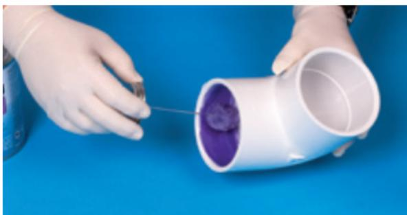
**10.** Enseguida, agresivamente aplique el Primer en la parte final de la tubería a un punto de 1/2" (15 mm) mas allá de la profundidad del casquillo de la conexión.
