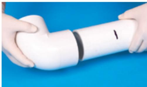
7. Use el aplicador adecuado para el tamaño de la tubería o conexiones que van a ser unidos. El tamaño del aplicador debe ser por lo menos la  $\frac{1}{2}$  del diámetro de la tubería. Es importante que un aplicador de tamaño satisfactorio sea usado para ayudar asegurar que las capas suficientes de cemento sean aplicadas.
