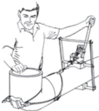
7. La tubería y la conexión de diámetro grande requiere tiempos de secado y fraguado mas largos. \* (En clima frío una cobija calentadora puede ser usada para acelerar los tiempos de secado y fraguado).
