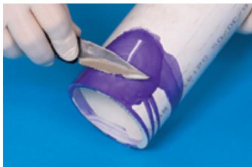
examinando su efecto suavizante, provee seguridad de que las superficies están preparadas para una fusión en una amplia variedad de condiciones. Examine la penetración o suavización en una pieza de tubo sobrante antes de que usted empiece la instalación o si el clima cambia durante el día.
