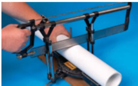
3. Cortadores de tubería de plástico también pueden ser usados. Sin embargo, algunos producen un reborde levantado al final de la tubería. Este reborde debe ser removido con una lima o escariador. El reborde quitará el cemento cuando la tubería sea insertada en el casquillo de la conexión.
