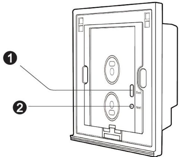
2. Salga de la red de ZigBee Presione prolongadamente la Tecla multifuncional 10 segundos, el Indicador del sistema parpadeara 4 veces y luego saldrá. El equipo restablecerá los ajustes de fábrica y saldrá de la red ZigBee.
