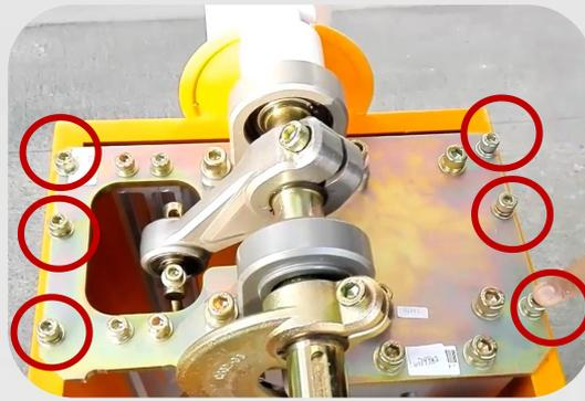
3. -Una vez que hayamos desmontado el mecanismo, quitamos el eje retirando los 4 tornillos de sujeción del mecanismo.
