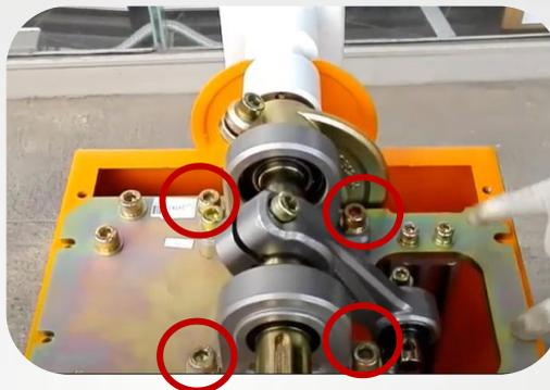
4. - Posteriormente quitamos los 4 tornillos que sujetan al motor para nuevamente colocar un nuevo motor.
