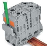
Puenteado con puente contigo: inserte el puente encima del agujero del punto de conexión antes de conectar el conductor. La sección nominal sigue siendo la misma.
