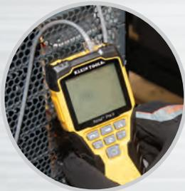
**Detecta, identifica y prueba la alimentación eléctrica a través de Ethernet (PoE)**
