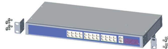
Figura 2-1 Diagrama de instalación de soportes
