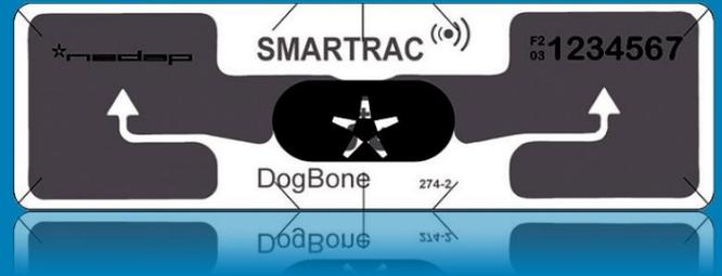
El Tag UHF exterior es una etiqueta de identificación del vehículo. La etiqueta está montado en el exterior de un vehículo, ofreciendo rentable identificación de largo alcance para aplicaciones de aparcamiento.
