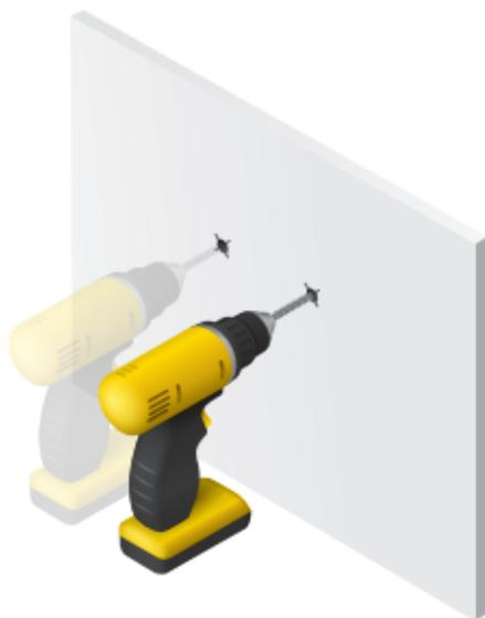
3. Inserte los anclajes de los tornillos en los orificios pretaladrados y asegure el *Montaje en pared* utilizando el *Tornillos de montaje*.
