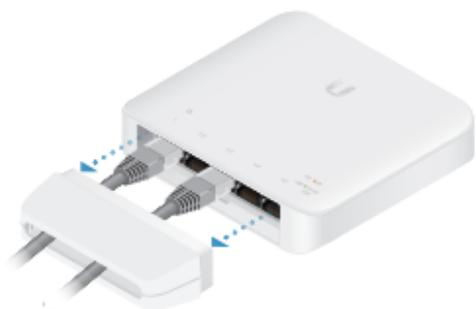
2. Desconecte los cables Ethernet del USW-Flex.
