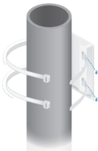
2. Presione el interruptor sobre el *Montaje en poste* y deslícelo hacia abajo hasta que encaje en su lugar.
