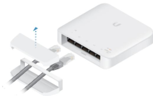
4. Deslice los cables Ethernet a través de la apertura de la *Cubierta del puerto*.
