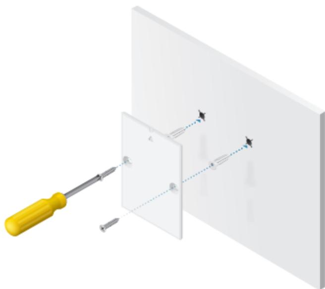
4. Monte el interruptor en la pared presionándolo sobre el *Montaje en pared* y deslizándolo hacia abajo hasta que encaje en su lugar.
