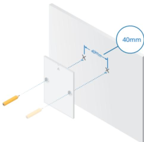
2. Use una broca de 6 mm para perforar previamente los dos orificios.
