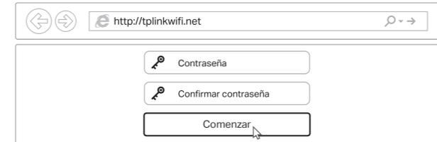
3. Ejecute la Configuración Rápida, seleccione Router inalámbrico y siga las instrucciones paso a paso para configurar la conexión a Internet.
