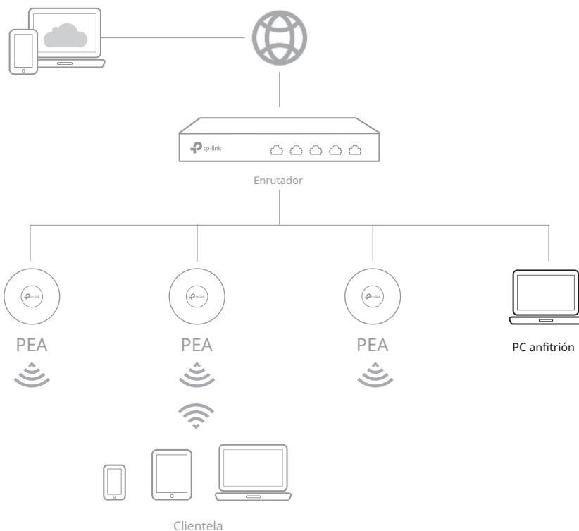
1. Conecte una computadora a un puerto LAN del enrutador con un cable RJ45 de manera adecuada. Si su computadora está configurada con una IP fija, cámbiela a obtener una dirección IP automáticamente.
