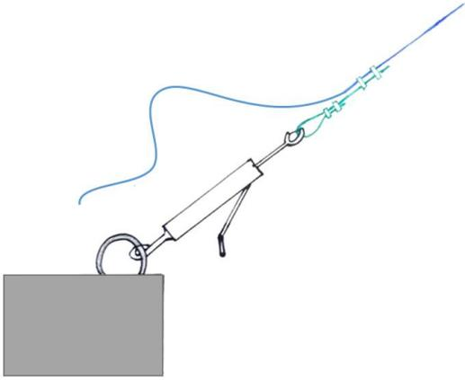
1. Se coloca el nudo de sujeción temporal (en verde) en la retenida a tensar. Se coloca al mismo tiempo el malacate en su posición (no tensado) sujetando un lado el anclaje de la retenida y el otro al sujetador temporal en verde.
