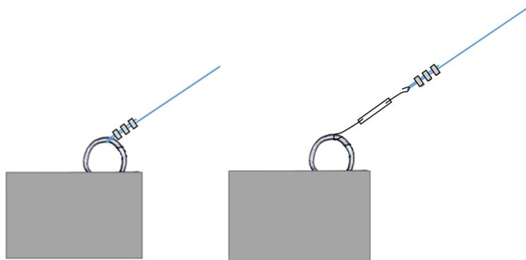
3. Se procede a liberar el malacate para desconectarlo y retirarlo de la instalación. Se retira también el nudo temporal a tensar. Aquí existirá un pequeño destensado de valor despreciable.
