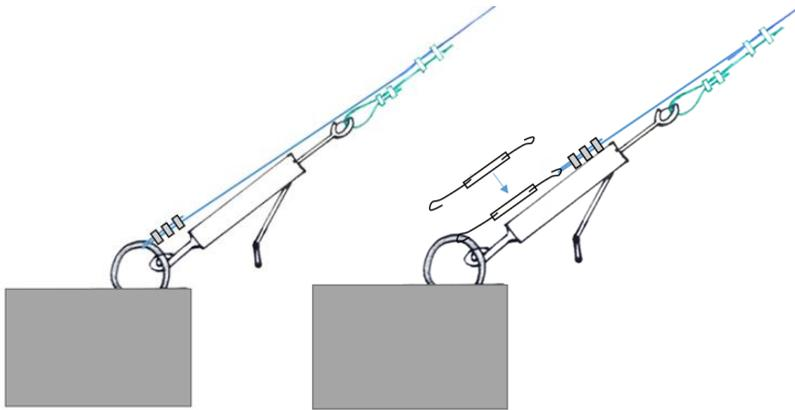
2. Se procede a anudar el cabo suelto de retenida directo al anclaje o al tensor (en caso de utilizarlo) de forma manual y con ayuda de 3 nudos de la medida correspondiente.
