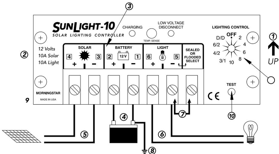
6. Conecte por último la LUZ “LIGHT”. SI el LED rojo se enciende, esto indica que la capacidad de la batería está baja y que debe ser cargada antes de completar la instalación del sistema. (Ver la sección 6.4).
