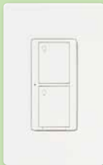
Dimensiones del interruptor con 2 botones 5 A An: 75 mm (2.94") Al: 119 mm (4.69") Prof: 38 mm (1.44")
