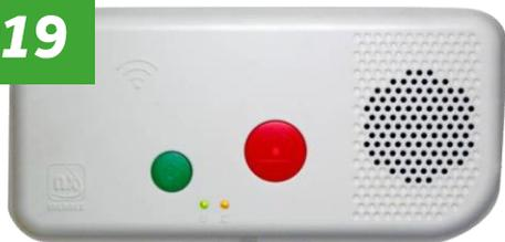
**El Terminal de superficie NX0019** es uno de los más adecuados a la hora de renovar instalaciones por su sencilla colocación y porque posee integrados: micrófono, altavoz, 2 conectores para pulsadores de alarma NX0881 y lector de tarjetas RFID (125KHz o MIFARE)
