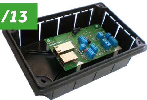
**El Terminal de empotrar NX0011/13** puede ocultarse en un falso techo o en un cabecero permitiendo ganar en flexibilidad a la hora de diseñar la colocación de los diferentes periféricos en la habitación (micrófono, altavoz, pulsadores de alarma, ...)
