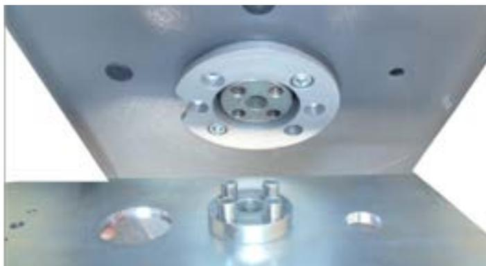
2.- Colocar el montaje al eje de salida de la barrera con 4 tornillos hexagonales m10. Entre la placa principal y el eje se salida debera colocarse el anillo separador incluido.
