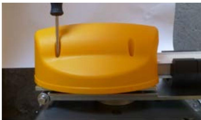
6.- Colocar la carcasa protectora con 4 tornillos de 3/6".
