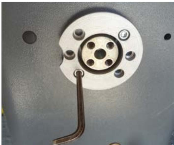
1.- Colocar el anillo de retención al gabinete mediante 4 tornillos m8. La muesca del anillo debera apuntar en dirección hacia donde quedara la barra.
