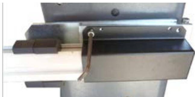
5.- Colocar el enganche para sujetar la barra a la placa mediante 4 tornillos de 5/16", asegurándose que la barra llegue hasta el fondo del enganche y apretar firmemente.
