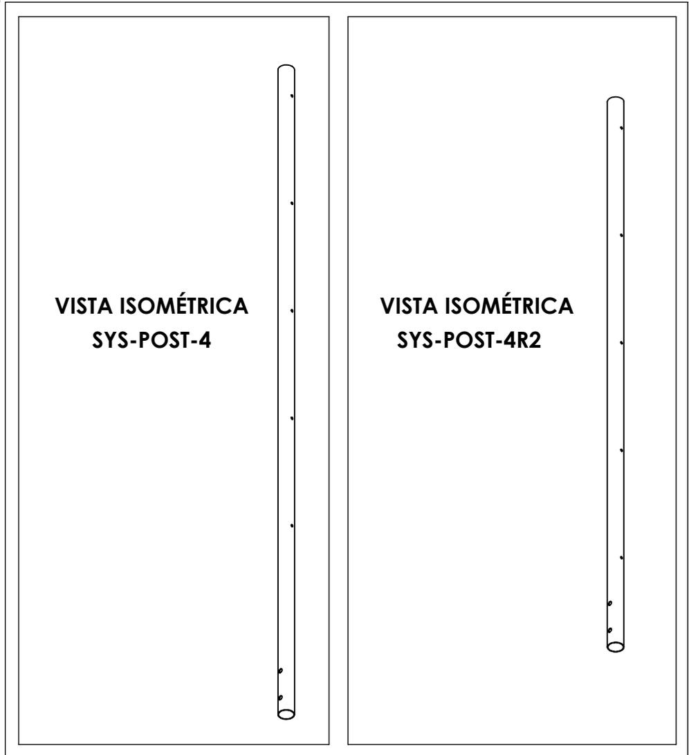
1. Fabricado en Tubo de Acero galvanizado cal. 18 de 1".
