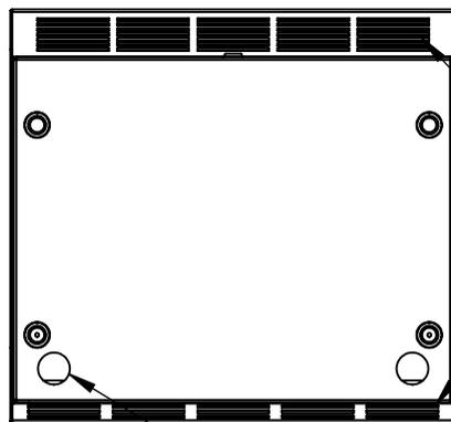
Ranuras de ventilación y extracción de aire
