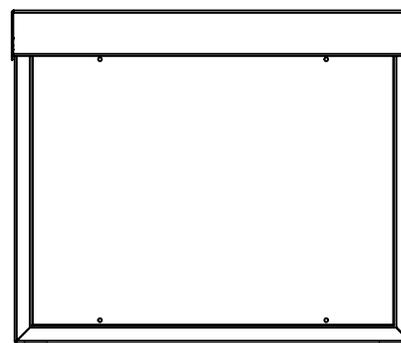
1. Fabricado en lámina de acero galvanizado calibre 18.
