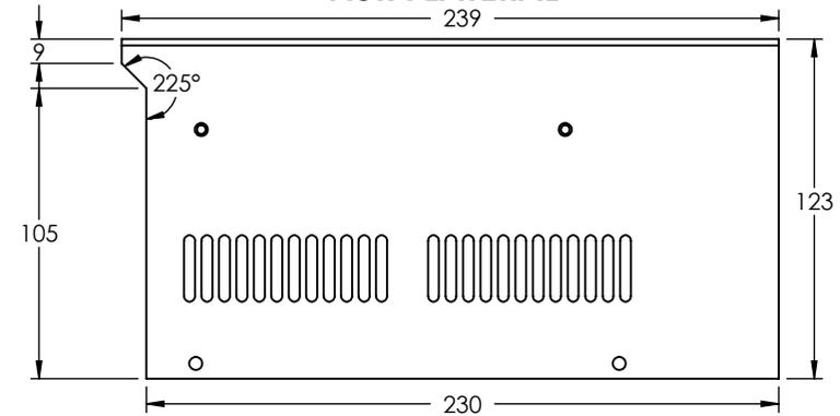
1. Fabricado en lámina de acero rolado en frío calibre 22.
