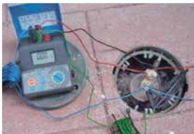
La distancia de separación del electrodo y la punta de corriente del terrómetro (trayectoria A-C) debe ser de al menos 10 m.
