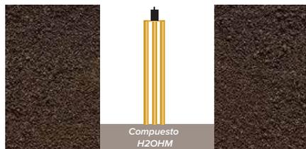
Si le sobró H2OHm, continúe poniendo capas del mismo y compacte hasta que utilice todo el sustrato adecuado para el electrodo que está instalado.
