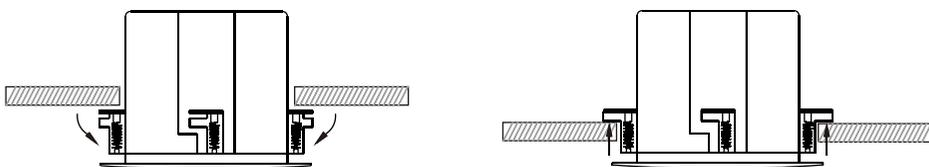
Paso 1.- Con las herramientas requeridas, marque el diámetro del altavoz en el techo o plafón, para perforarlo.
