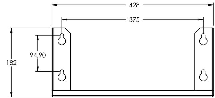
1. Fabricado en lámina rolado en frio calibre 16.
