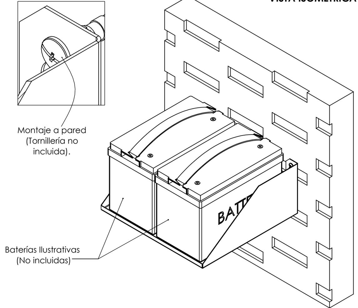
1. Fabricado en lámina rolado en frio calibre 16.
