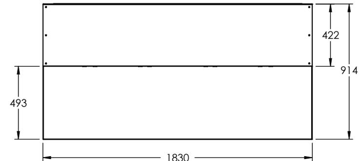
1. Fabricado en lámina de acero en calibre 16 y 18.
