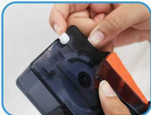
1. Desatornille el tornillo de la cubierta lateral
