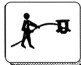
Desenrollar rodando verticalmente el rollo, se evitarán distorsiones al cable. Para enredar, proceder a la inversa.
