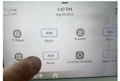
Ejecute la prueba "SRF". Espere hasta 2 minutos para que el panel pruebe correctamente la radio en la nueva tarjeta IQ. Si la prueba falla, reinicie el panel e intente nuevamente.
