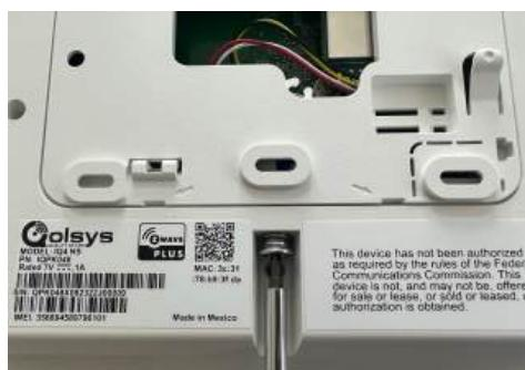
Desde la parte inferior del panel, busque el tornillo de retención y afloje completamente.
