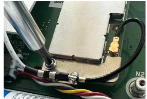
Instale y ajuste el tornillo de bloqueo provisto para fijar la tarjeta IQ en su lugar. Asegúrese de que la antena permanezca conectada y no interfiera con la batería.
