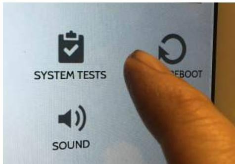
Desliza el dedo hacia abajo y toca "Configuración" y luego "Configuración avanzada". Ingresa tu código y toca "Pruebas del sistema".
