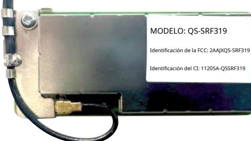
La tarjeta IQ-319 se puede instalar en la "Ranura 3" de su IQ Panel 4, IQ4 Hub o IQ4 NS para habilitar la compatibilidad con sensores S-Line aprobados y SRF heredados de 319,5 MHz.
