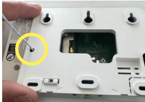
Asegúrese de que la antena SRF blanca salga por el orificio de la placa posterior. Presione hacia abajo en la parte inferior y ajuste el tornillo de retención.
