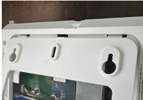
Vuelva a colocar la cubierta posterior, comenzando por las pestañas superiores.
