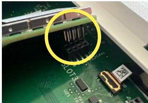
Haga coincidir los pines de la parte inferior de la tarjeta IQ con el terminal del panel IQ.
