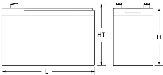
Tolerancias de +/- 1 mm (+/- 0.04 pulg.) y +/- 2 mm (+/- 0.08 pulg.) para dimensiones de altura.
