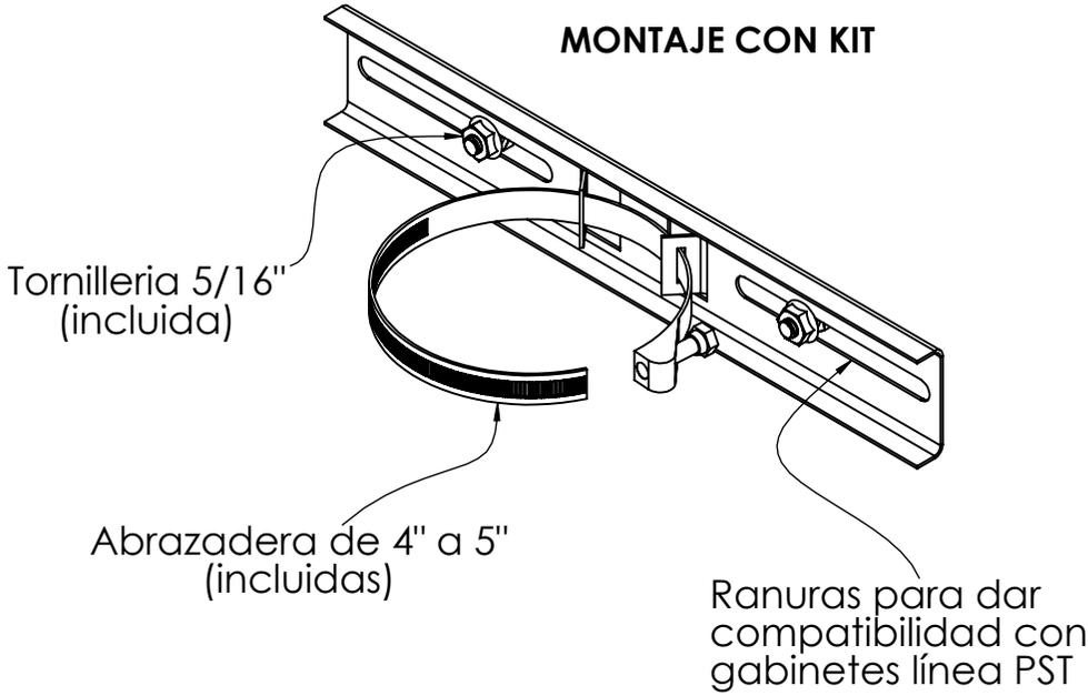
1. Fabricado en lámina en acero galvanizado calibre 18.
