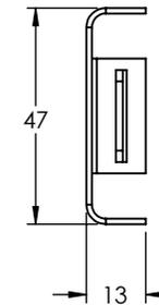
1. Fabricado en lámina en acero galvanizado calibre 18.
