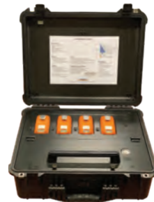
Estación de Funcionalidad Calibración y Pruebas
