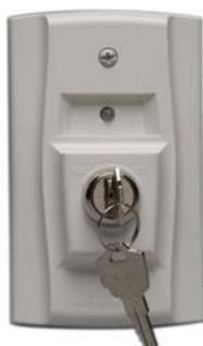
El accesorio de pruebas remoto permite probar el detector de haz y restablecerlo de forma remota desde nivel suelo. Proporciona funciones de prueba y restablecimiento, y tiene indicadores LED de color verde y rojo que imitan los del detector.
