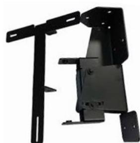
La unidad 6500MMK permite montar detectores óptico lineales y reflectores en una pared vertical o en el techo. El kit permite un rango de alineación adicional para los casos en los que el detector y el reflector no se puedan montar con 10° de separación. Además, el kit incluye el hardware necesario para montar una sola unidad de transmisora/receptor o un solo reflector.
