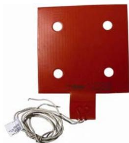
La unidad BEAMHKR permite que el reflector funcione en ambientes propensos a la formación de condensación. La condensación que se forma en el reflector puede dar lugar a fallas o condiciones de falsa alarma. La unidad BEAMHKR disminuirá la probabilidad de condensación, manteniendo el reflector a una temperatura ligeramente superior al aire circundante. El kit requiere una fuente de alimentación de 24 V.
