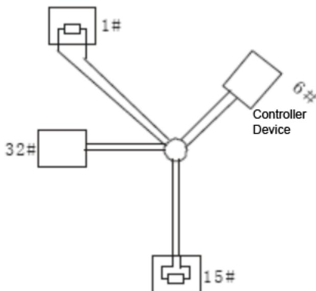
Para solucionar los problemas, se recomienda utilizar distribuidores RS-485. El distribuidor RS-485 puede ayudar a evitar problemas de conexión comunes para mejorar la calidad de la transmisión.
