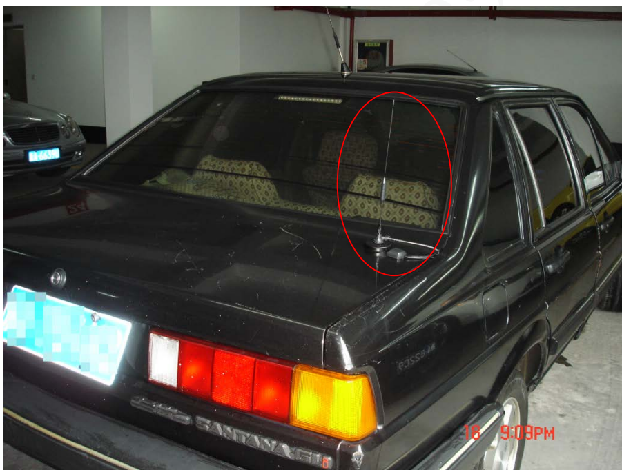
Figure 2-18 Instalación exterior de Antena Red Móvil
