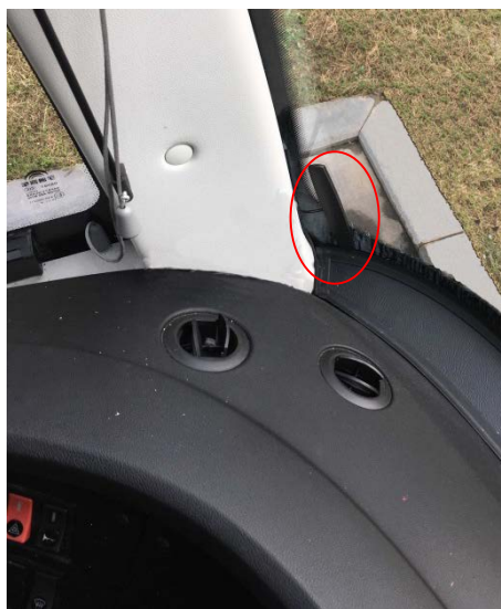
Figure 2-18 Instalación exterior de Antena Red Móvil
